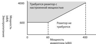
Условия установки реактора
