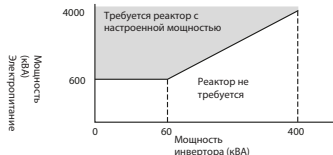
Условия установки реактора
